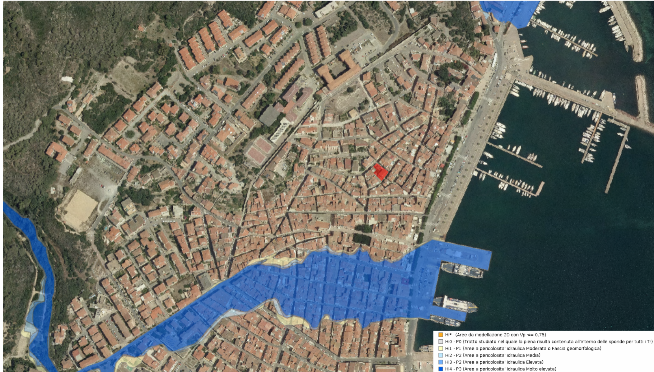
IU-06 PAI - Pericolo Idraulico 1:5000
